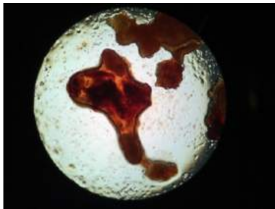
Figura 1. Microscopía óptica de la afinidad de la ralladura de aguacate por los hidrocarburos.
