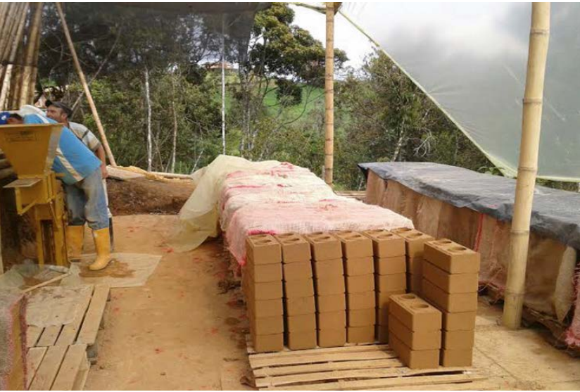
Figuras 4 y 5. Planta de producción in situ, almacenamiento y curado de BSC en obra
